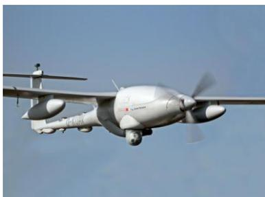
Le Patroller a été commandé à 14 exemplaires (avec 6 stations au sol) en 2016. Destinés à remplacer les actuels drones tactiques Sperwer (SDTI), ces appareils peuvent emporter une charge utile de 250 kg (dont une boule optronique gyrostabilisée pour l'observation et l'identification jour/nuit à grande distance et un radar SAR/GMTI pour détecter les cibles mobiles) et voler à une altitude de 6 km pendant au moins 14 heures.
